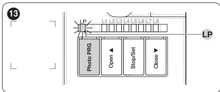
Чтобы отключить функцию «Программирование фотоэлементов», удерживайте нажатой кнопку **Photo PRG** до тех пор, пока не погаснет светодиод «LP».
