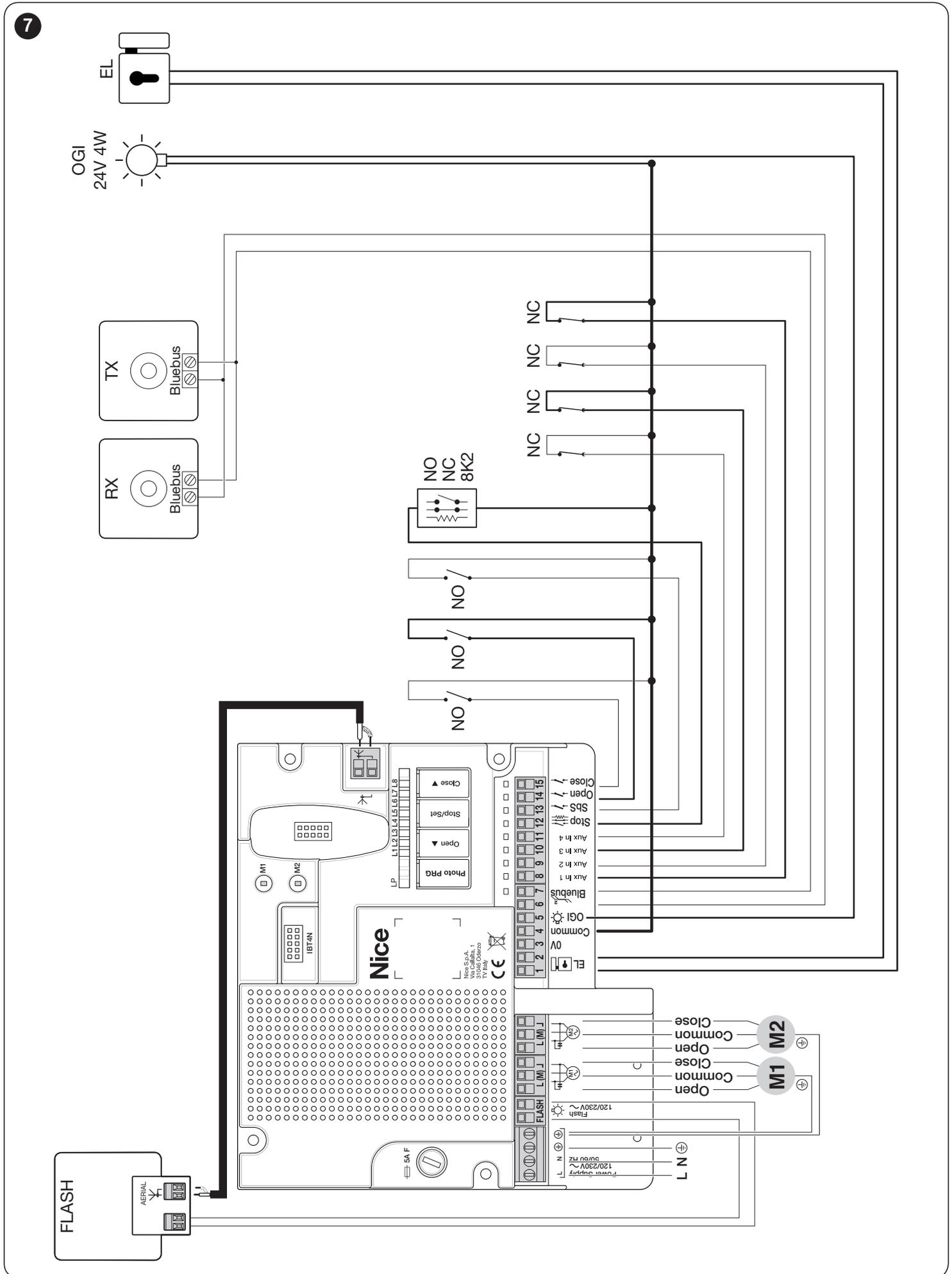
4.2.3 Схема соединений с релейными фотоэлементами с функцией «Фототест»
