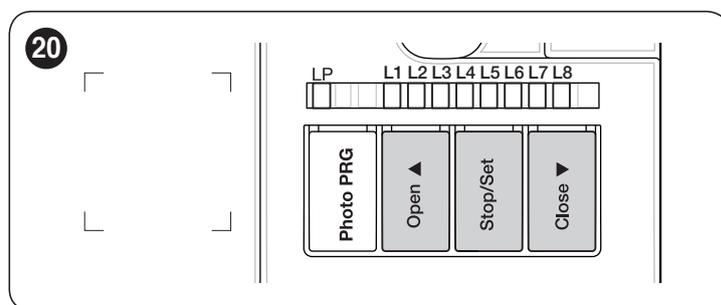
Доступные программируемые функции относятся к **двум уровням**, а их рабочий статус отображается при помощи восьми светодиодов «L1 ... L8» имеется на блоке управления (светодиод горит = функция активна; светодиод не горит = функция отключена).
